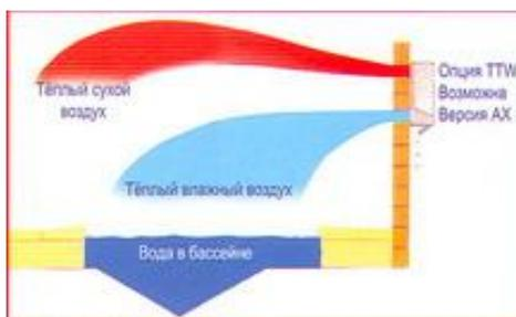
**АХ- Функция размораживания.** Данная опция позволяет эксплуатировать осушитель при низкой температуре воздуха. В целях экономии в период, когда бассейн не используется, вы можете значительно снизить температуру воды и воздуха в помещении бассейна. Функция размораживания позволяет эксплуатировать осушители при температуре воздуха до 5С (для некоторых моделей до 0С), обеспечивая при этом эффективное осушение воздуха без риска обмерзания теплообменника внутри осушителя
